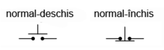
Fig. 4-13 simbolul comutatorului tip buton în poziția normal-deschis, respectiv normal-închis
