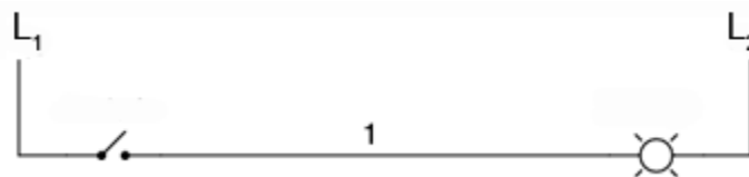
Fig. 6-1 diagrama ladder de control a unei lămpi prin intermediul unui comutator manual
