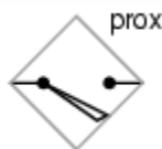
Fig. 4-6 comutator de proximitate; simbol
