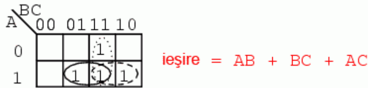
Fig. 8-44 incinerator deșeuri toxice - simplificarea circuitului logic folosind hărți Karnaugh
